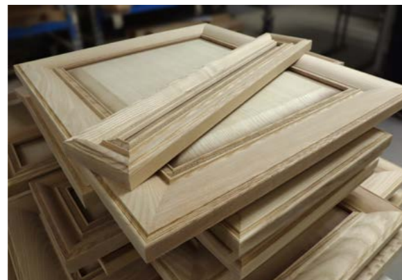
Участок шлифовки фасадов перед процессом окрашивания.
