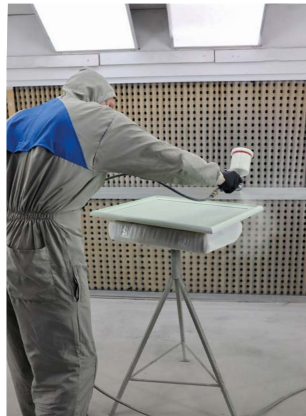
Окрашивание фасада в малярной камере.
