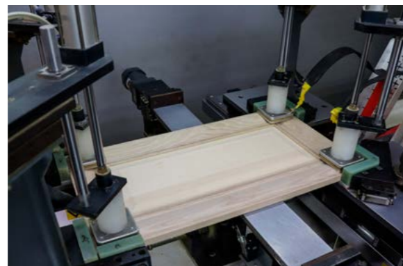
Сборка заготовки фасада из массива с использованием станка ТВ4.
