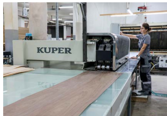
Сращивание шпона на итальянском оборудовании.
